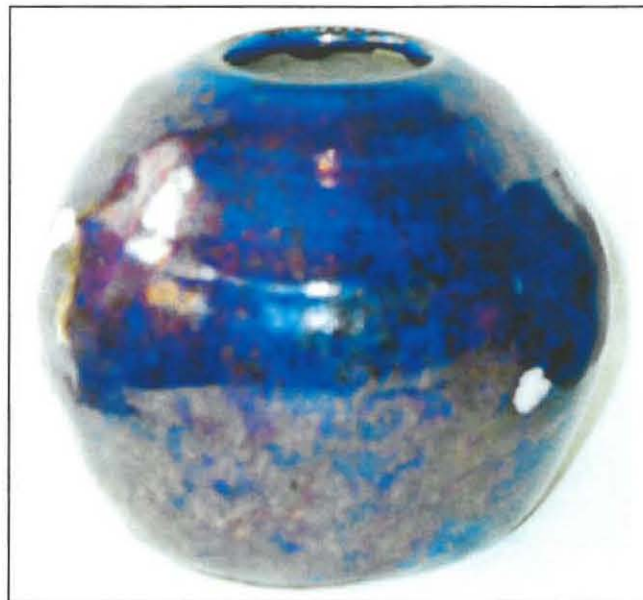
Figuur 31: Toetsstuk van glasuur no. 7 met byvoeging van kobalt, koperkarbonaat en swart koperoksied.
