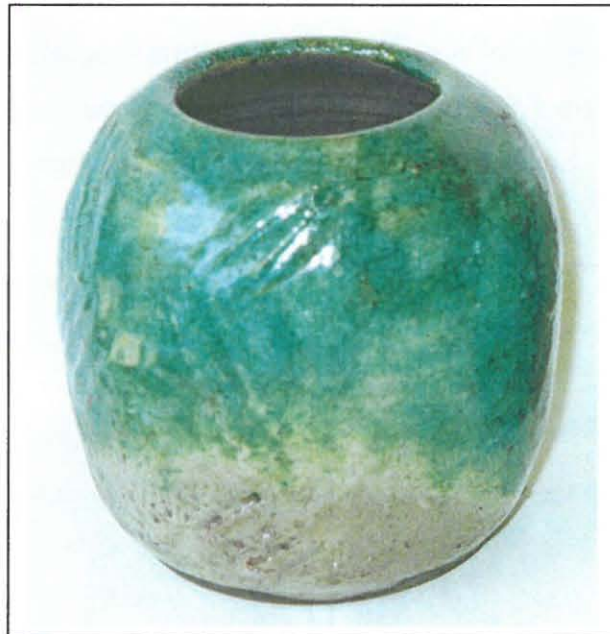
Figuur 2: 'n Toetsstuk waarvan die glasuur weggebrand het. Glasuur no. 1.
