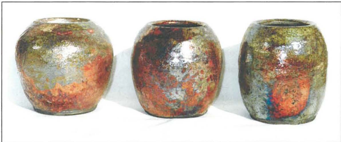
Figuur 6: Toetsstuk van glasuur no. 6 met byvoeging van koperkarbonaat.
