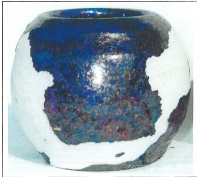
Figuur 26: Toetsstuk van glasuur no. 7 met byvoeging van kobalt en koperkarbonaat.
