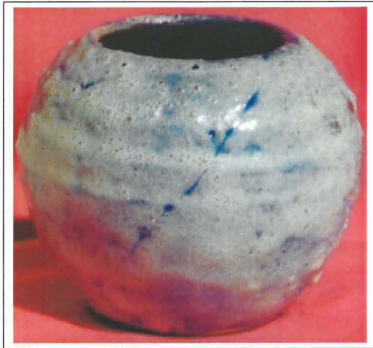
Figuur 39: Toetsstuk van glasuur no.1 met aanwending van koblat op beskuitware.
