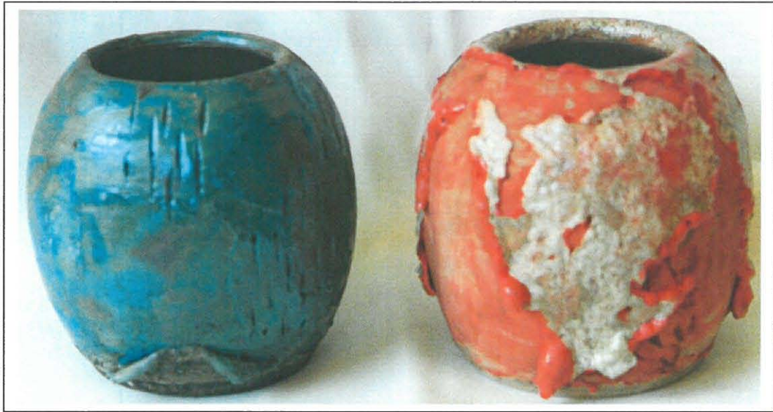
Figuur 12: Toetsstuk van glasuur no. 6 met die aanwending van kleurstof onder glasuur.
