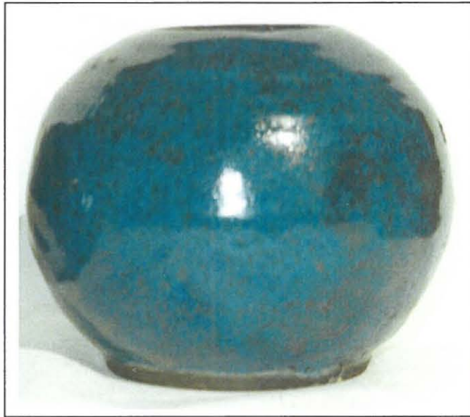
Figuur 37: Toetsstuk van glasuur no. 1 met byvoeging van koperkarbonaat, kobalt en swart koperoksied.
